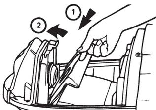
3) Nový sáček na prach vložíte zasunutím jeho kartónového okraje do vodících lišt s následným přitlačením dopředu.
