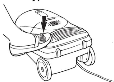
Vysavač zapnete a opět vypnete stisknutím nášlapného tlačítka
