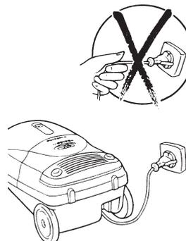
4) Vytahujete-li síťový přívod ze zásuvky, uchopte síťovou vidlici, nikdy netahejte za samotný kabel.
