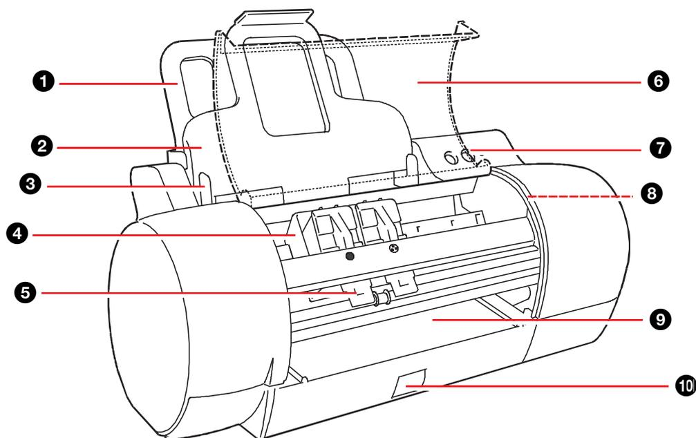
(1) Hlavný automatický podávač (s držiakom papiera) - (2) Výstupný držiak / Druhý automatický podávač (s držiakom papiera) - (3) Okrajová vodiaca lišta - (4) Vozík tlačovej hlavy (s vloženými tlačovými hlavami) - (5) Páčka pre uvoľnenie tlačovej hlavy - (6) Kryt (otvorený) - (7) Ovládací panel (dve tlačidlá a svetelný indikátor) - (8) Parkovacia poloha tlačovej hlavy (pod krytom tlačiarne) - (9) Ručný podávač - (10) Uvoľňovacie tlačidlo (pre vybratie pokrčeného papiera - v prípade potreby)
