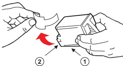
**Nedotýkajte sa elektrických kontaktov (① zlatistá časť) ani tlačových dýz (②) a ani na ne tlačovú hlavu nepokladajte.**
